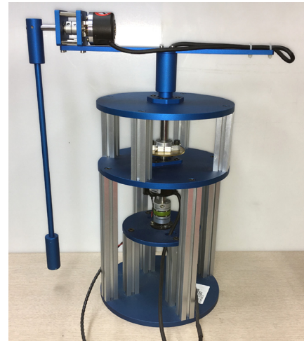
그림 1. 실험실에서 제작한 회전형 도립진자 시스템. Fig. 1. Lab-built rotary inverted pendulum system.
