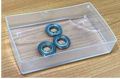
그림 8. solvent를 이용한 bearing의 grease 제거. Fig. 8. Removal of bearing grease using solvent.
