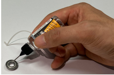
그림 9. bearing 전용 oil의 적용. Fig. 9. Application of oil to the bearing.
