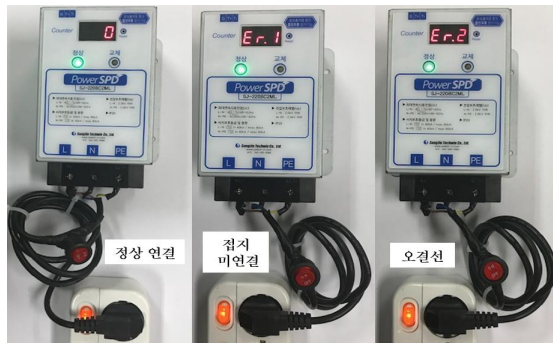
그림 16 오결선 실험 구성 Fig. 16 Miswiring test setup
